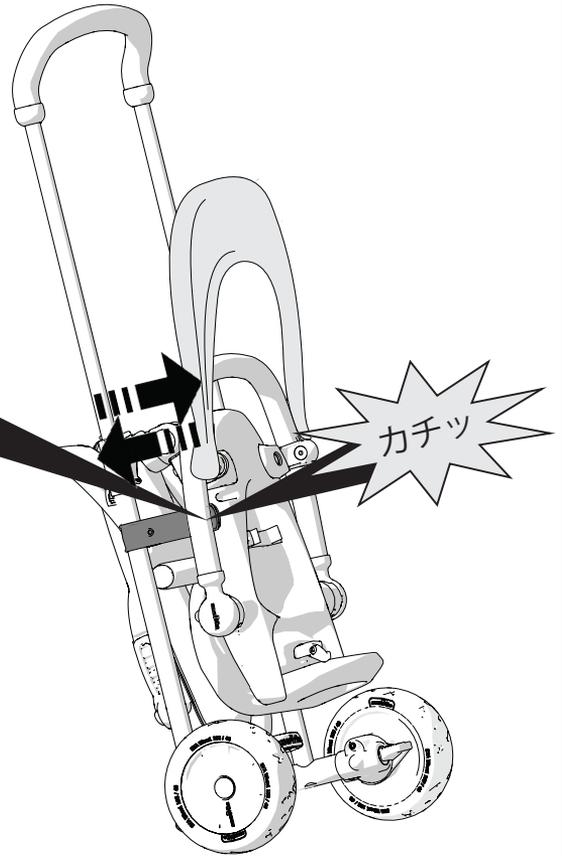
図のようにロックレバーが留め具に引っかかるようにロックします。安全ガードとコントロールバーを両手で挟んで握るとロックしやすいです。
