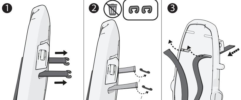
1才半頃～は図の手順でショルダーベルトの高さを調節してください。
