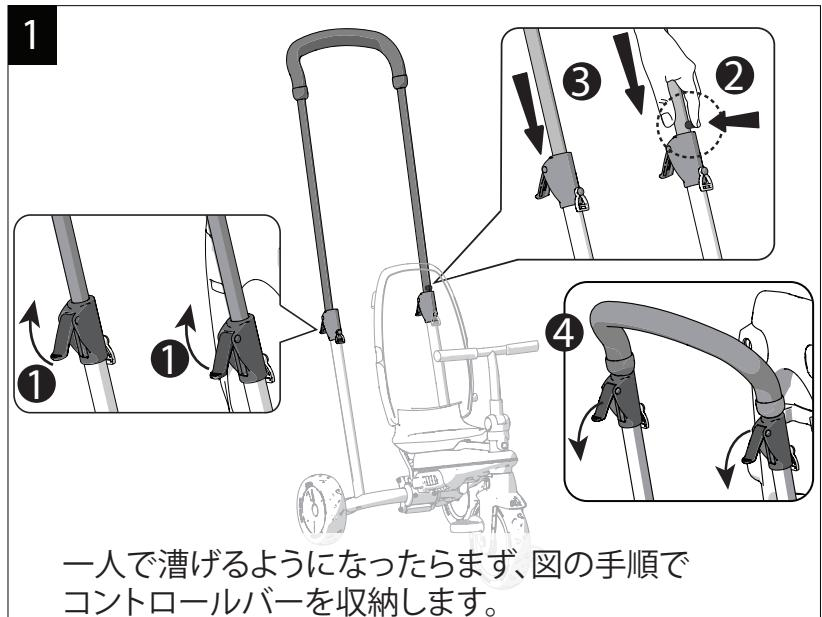
一人で漕げるようになつたらまず、図の手順でコントロールバーを収納します。
