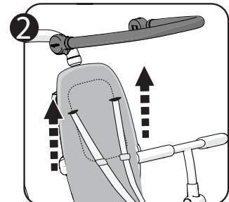
次に、安全ガード根元のロックレバーを手前に引きながら、安全ガードを上方向に外します。
