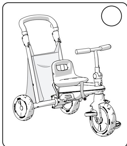
股ベルトを固定しているネジを外します。
